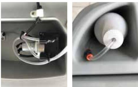
Trion 2040 può essere dotata di serie del sistema di regolazione del detergente la cui percentuale (fissa con 4 valori: 0,2%-0,5%-1%-1,5%) è impostata dal display con una semplice operazione. Cio' consente una precisa calibrazione della quantità di prodotto chimico in funzione dell'applicazione. Si evitano quindi sia sprechi di detergente rispetto alla dosatura manuale nel serbatoio dell'acqua che ristagni di prodotto nel serbatoio.
